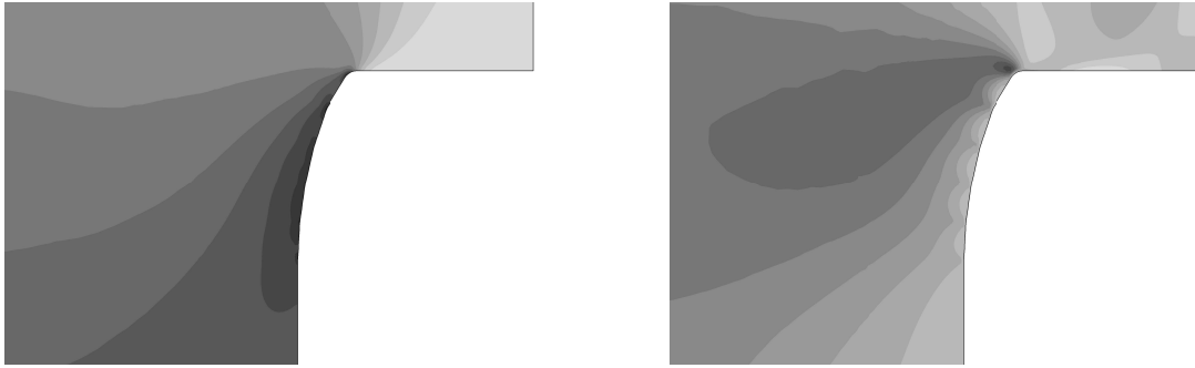
Abbildung 4.11.: v.Mises-Spannung und Querkzugspannung an der multilinearisierten Kerbform
