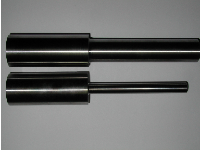
Abbildung 5.2.: Proben mit D/d = 1,4 und D/d = 3,0
