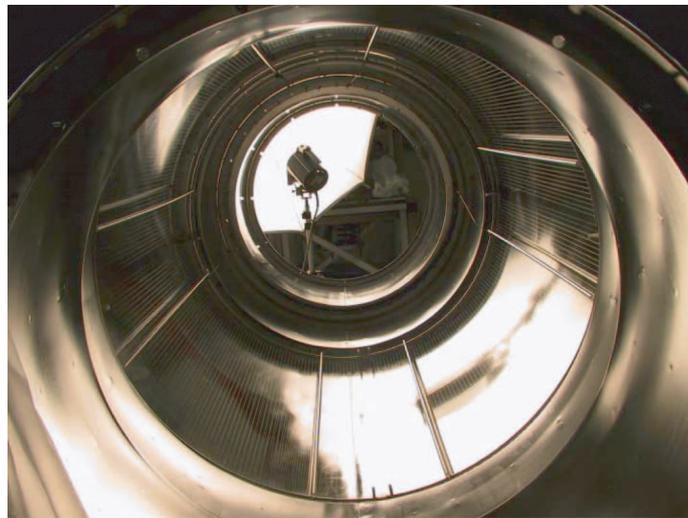
Abbildung 4.2: Schematische Darstellung der Elektroden im umgebauten Mainzer Spektrometer und Bild der Zentralelektrode und der eingebauten Drahtelektrode (rot).
