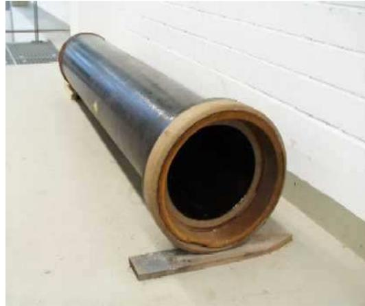
**Tab. 5.1:** Herstellerangaben Steinzeugrohr    **Abb. 5.9:** Steinzeugrohr DN300
