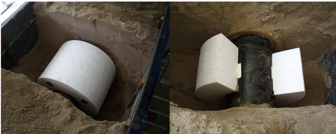
**Abb. 5.10:** 360° Hohlraum in maximaler Breite von  $b = 56 \text{ cm}$  (links) und 270° Hohlraum (rechts) mit einer Breite von  $b = 32 \text{ cm}$
