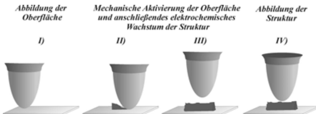
Abb. 2.37: Schritte zur Strukturierung durch mechanische Aktivierung von Oberflächen.
