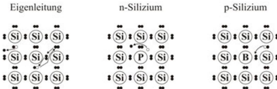
Abb. 2.15: Ladungstransport im Kristallgitter für eigenleitendes, n-dotiertes und p-dotiertes Silizium. Eigenleitung basiert auf thermisch angeregten Platzwechselfvorgängen. Bei Raumtemperatur geben in n-dotiertem Silizium die Dotierungsatome ihr fünftes Außenelektron (●) ab. In p-dotiertem Silizium wandern die „abgegebenen“ Löcher (o) der Dotierungsatome als „freie“ Ladungsträger durch das Kristallgitter.
