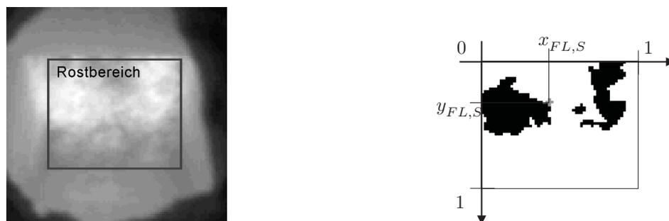
Bild 5.12: Infrarotbild  $\mathbf{F}_A$  mit markiertem Brennbettbereich, die detektierten Brennzonen und die mit  $\alpha_{BZ} = 0.9$  ermittelte Schwerpunktfeuerlage
