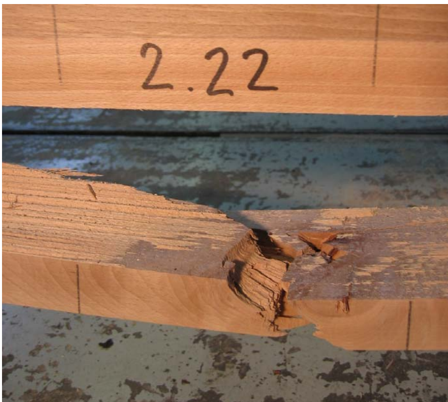
Bild B-16 Träger R6: Eindeutiges Ast-Versagen in Zelle 1.22
