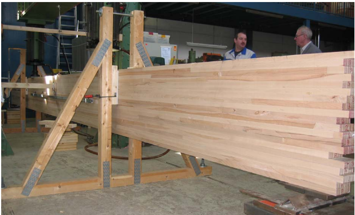
Bild B-2 Träger K1: Während des Biegeversuch nach DIN EN 408 mit Kippaussteifung
