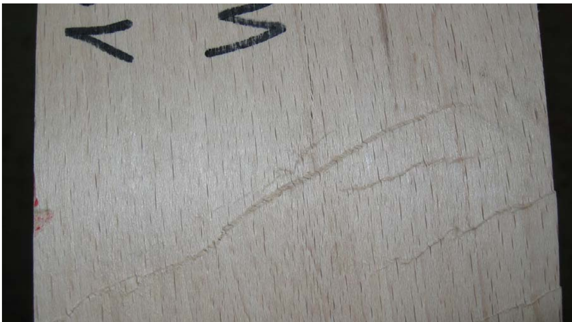
Bild B-12 Träger W15, Draufsicht: Druckfalten in Zelle 10.19
