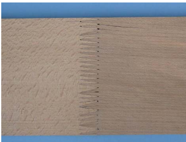
Bild C-5 Qualität 3 - Zinken greifen nicht ordnungsgemäß ineinander (Zinkensprünge), Ansicht der Biegedruckzone
