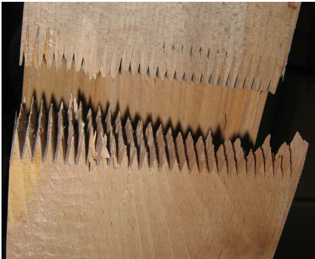
Bild B-10 Träger W1: Starke Faserneigung an einem Brett der Keilzinkenverbindung in Zelle 1.25
