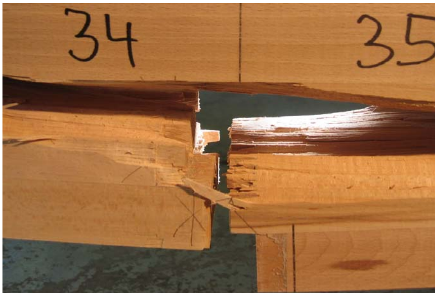
Bild B-18 Träger R8: Gemeinsames Versagen der Keilzinkenverbindungen in den Zellen 1.34 und 2.34
