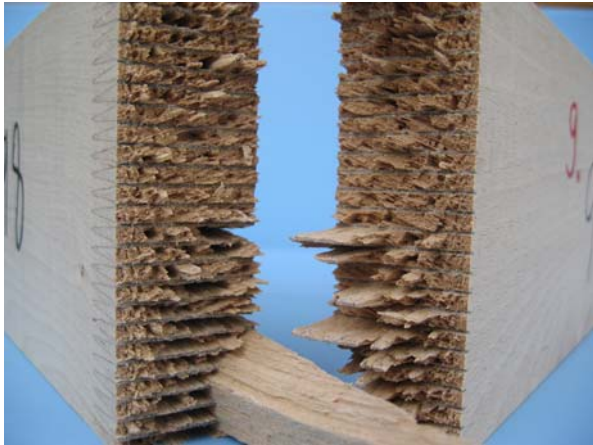
Bild C-3 Qualität 1 - Einwandfreies Fräsbild und sehr gute Verklebung, die sich durch vorwiegendes Holzversagen im Zinkengrund zeigt
