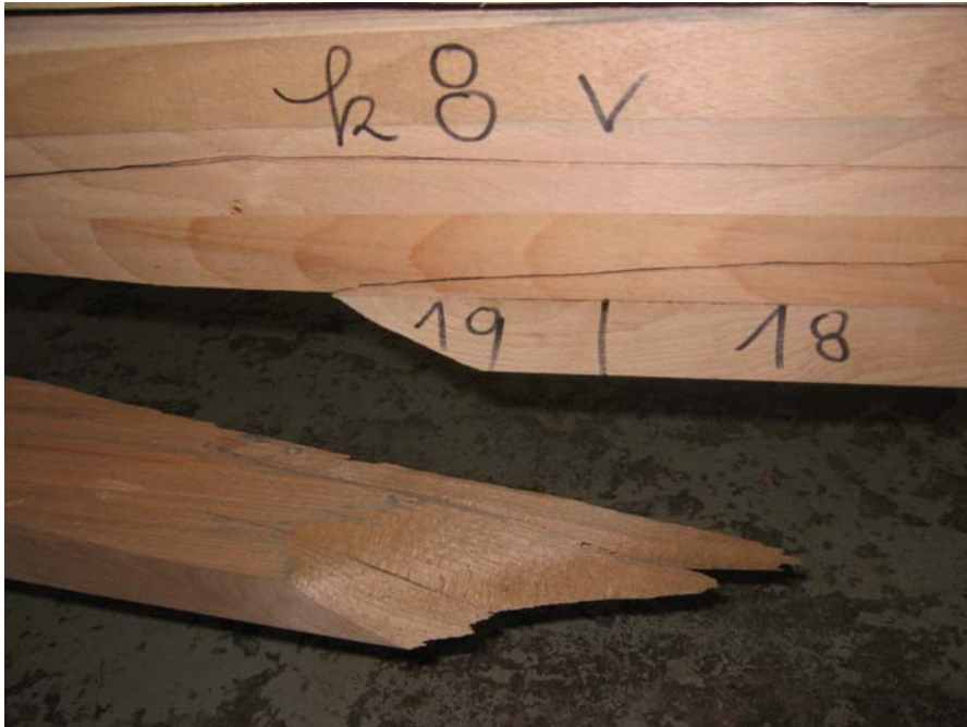
Bild B-15 Träger K8: Holz-Versagen in Zelle 1.18 bzw. 1.19 infolge starker lokaler Faserabweichung
