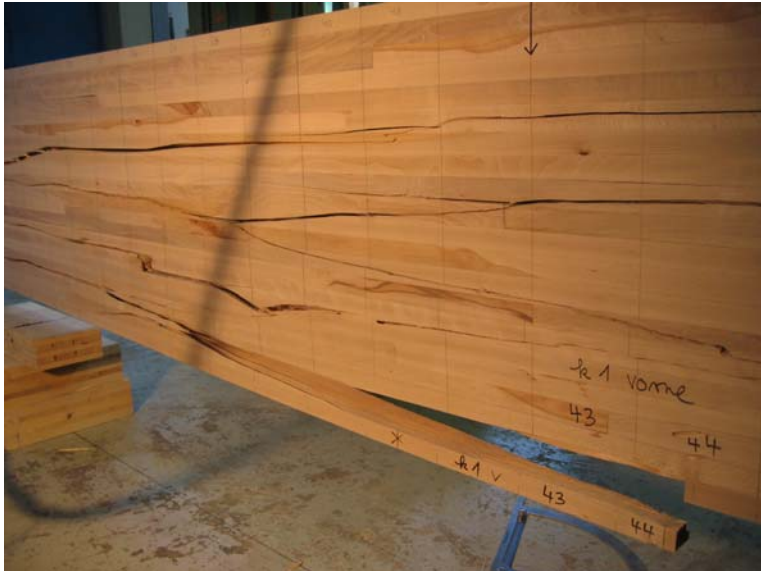
Bild B-13 Träger K1: Typische Rissmuster nach dem Bruch, zahlreiche Risse im mittleren Bereich zwischen den Lasteinleitungspunkten
