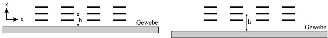
Abb. 8.4: Variation des Abstands. Der Abstand h von der Erregerspule zu der homogenen Schicht wird schrittweise verschoben.
