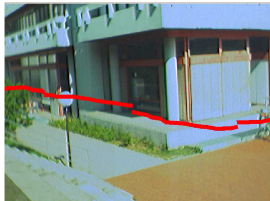
(f) Beispiel 3: Darstellung des Wasserniveaus mit Hilfe einer Linie - Laserscannerdaten als Phantom
