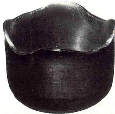
Bild 2.3.1: Beispiel für die Zipfelbildung beim Tiefziehen. Aus [Mecking 1998].
