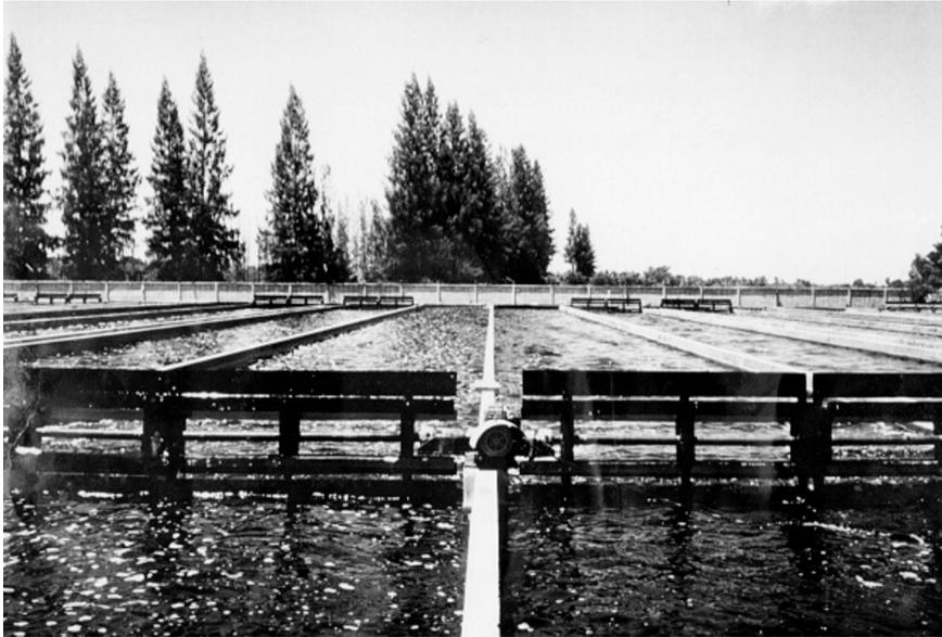
**Abbildung 2.8:** Photographie eines Raceway-Ponds, in dem *Chlorella* kultiviert wird. Die Lichtversorgung erfolgt mittels Sonnenergie. Eine homogene Durchmischung der Kultivierung wird durch den Einsatz von Schaufelrädern realisiert.
