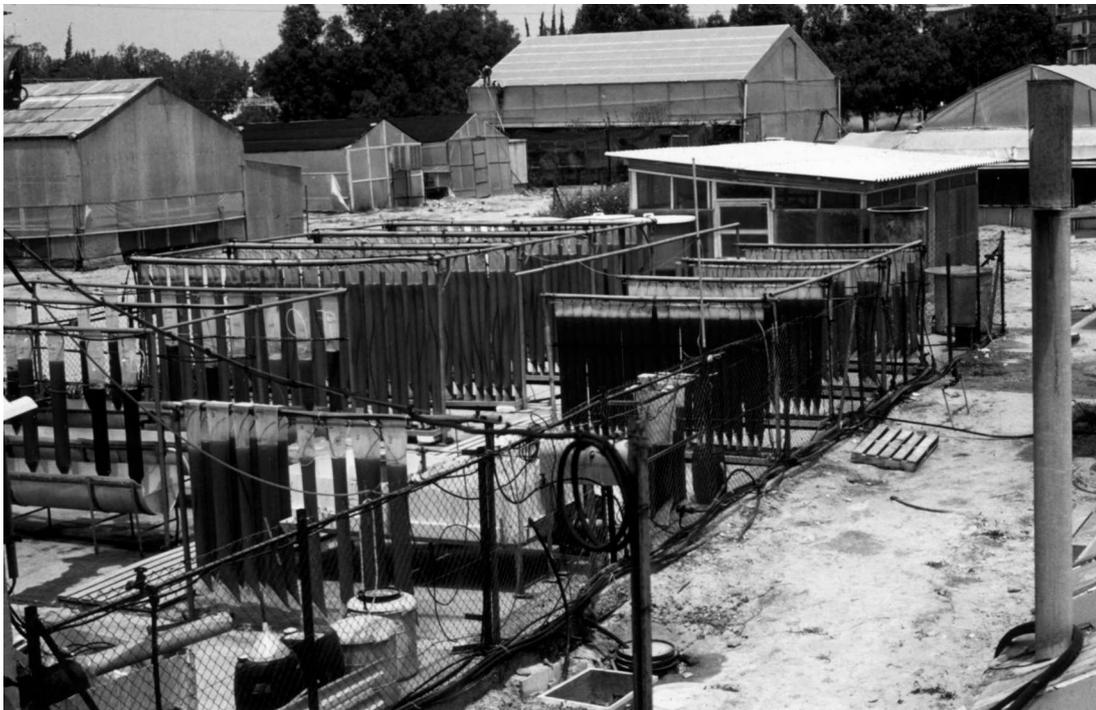
**Abbildung 2.9:** Polyethylen-Hülsen-Reaktoren mit einer Gesamtkapazität von 25 Litern, die für die Kultivierung der Mikroalge *Porphyridium purpureum* in Israel eingesetzt werden. Die Mikroalgen dienen als Nahrungsmittel für die Fischindustrie (Photographie vom „Institute of Applied Research“ in Beer-Sheva, Israel).
