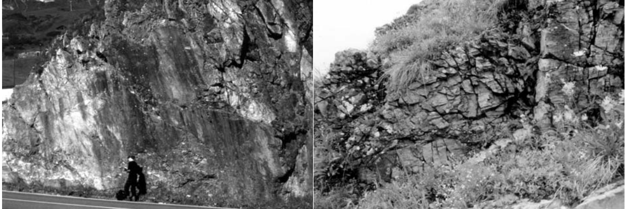
Abb. 7-3: Links: Großkluft in Hauptdolomit Formation (Aufschluss 46). Rechts: Kleinklüfte in Allgäu Formation. Bildausschnitt ca. 1 m hoch (Aufschluss 12).
