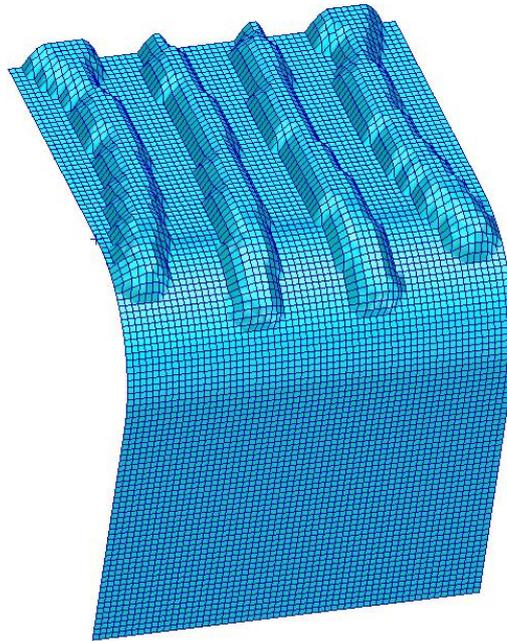
Abbildung 9.11: Computergestützt generierter Sickenentwurf,
