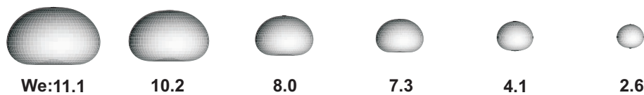
Abb. 3.3: Stationäre Tropfendeformation in Abhängigkeit der Weber-Zahl (Schmehl, 2003b)
