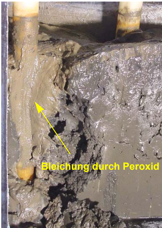
Abbildung B.8: (a) Sedimentoberfläche in Becken 3; (b) und (c) durch Wasserstoffperoxid gebleichte Bereiche im Sedimentkörper, Becken 3
