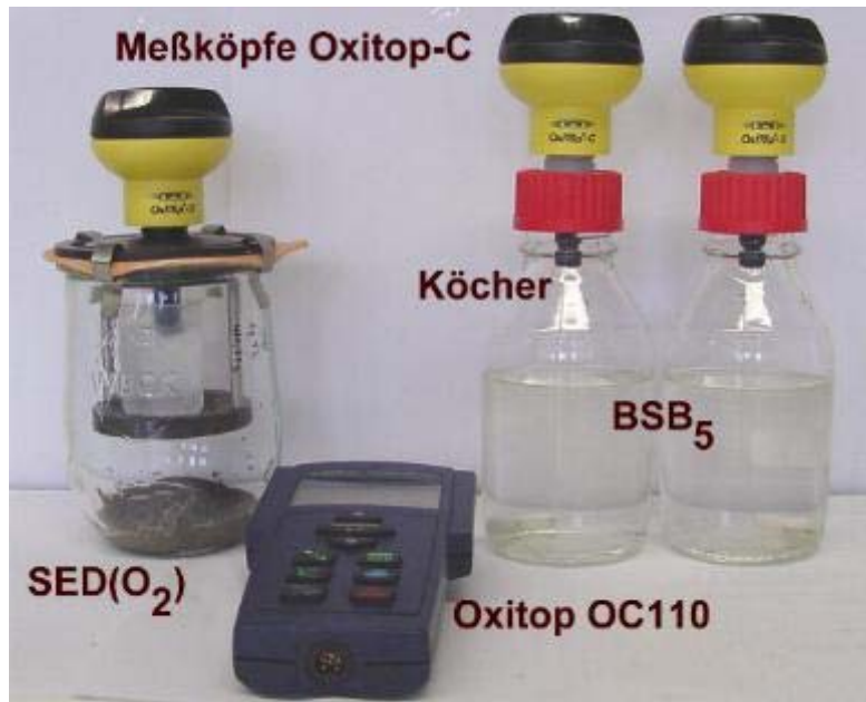
Abbildung A.1: Messanordnung für Sedimentatmung und BSB 5
