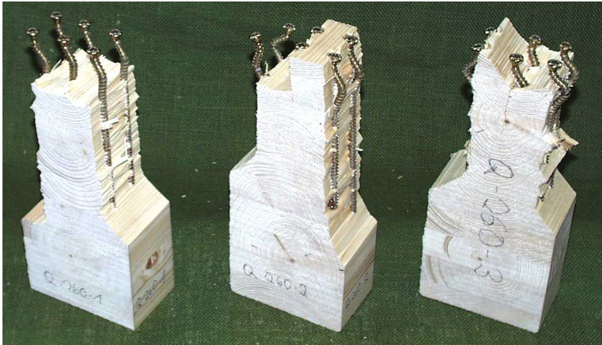
Bild 3-3 Versagensmechanismus: Ausknicken der Schrauben im Holz
