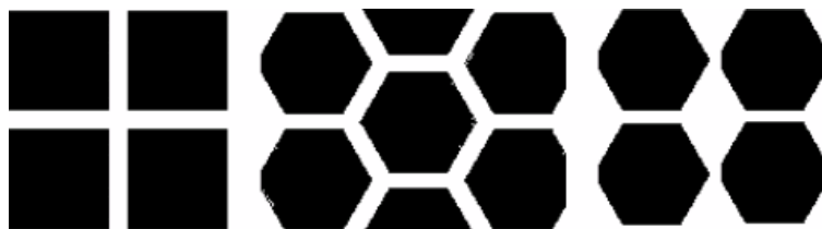
Bild 5.12: Beispiele für verschiedene Anodenmatrizen bestehend aus kleinen Elektroden (Quadrate, Waben; Sechsecke).
