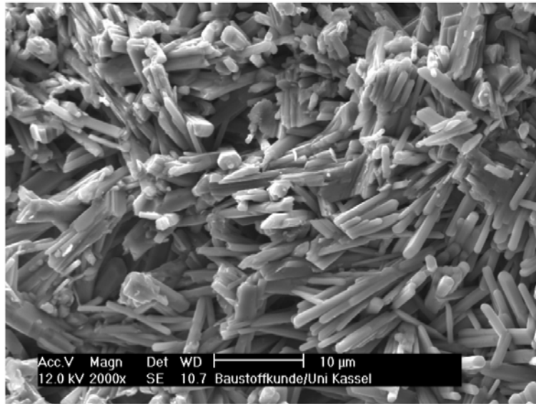
Abb. 1-1: Rasterelektronenmikroskopisches Bild einer abgebundenen Gipspaste. Ausgangsmaterial \beta -Halbhydrat (Middendorf, Universität Kassel, pers. Mitteilung)
