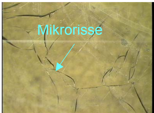
Abbildung 2-5: Mikrorisse beim Laserschweißen (PSU mit IRA)
