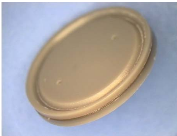
Abbildung 3-28: Eine verschweißte Ventileinheit aus PEEK
