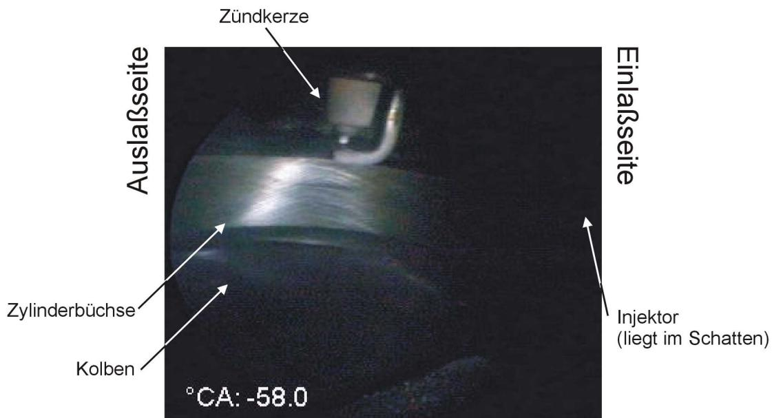
Abb. 6.33a: Blick durch das Endoskop in den Brennraum bei 58°KW v. ZOT
