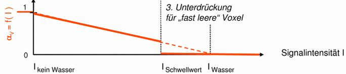
Abb. 6.4.: Zuordnung der Packungsdichte zur MRI Signalintensität (Hinweis: Schritt 3 in Vorgriff auf Kap. 6.3.3)
