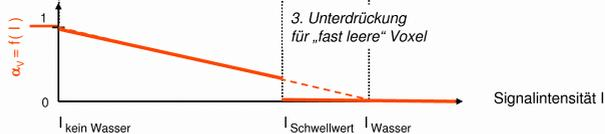
Abb. 7.4.: Zuordnung der Packungsdichten zu MRI Signalintensitäten und Schwellwert für die Auflösung von  $256^3$  Voxel
