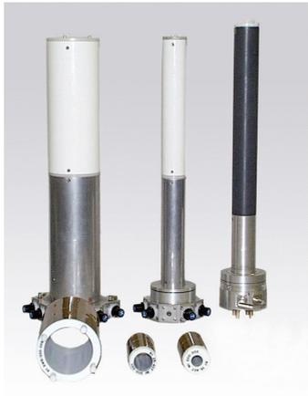
Abb. 6.2.: Vorhandene Probenköpfe für den Bruker SWB 200 MHz Tomograph mit verschiedenen Durchmessern für zylindrische Proben: 64, 25 und 15 mm
