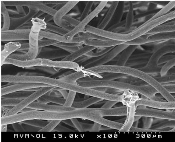
Abb. 6.1.: REM Aufnahme des Filtermediums: Packungsdichte ca. 1,7 %, Faserdurchmesser ca. 53  $\mu\text{m}$
