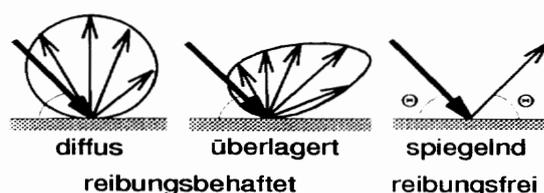
Abb. 4.11: Modelle für die Partikelreflexion an der Wand
