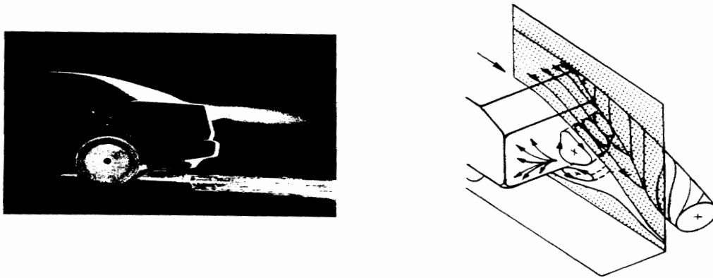
Abb. 5.14: Fotografie der Strömungsablösung am Kraftfahrzeug in einem Modellversuch und Prinzipskizze
