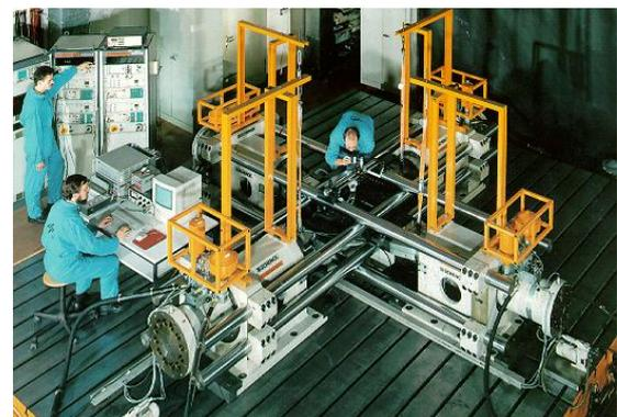
**Abb. 2.3:** Prinzip der Kreuzformprobenprüfung und technische Realisierung (oben: TU Darmstadt, unten: DLR)
