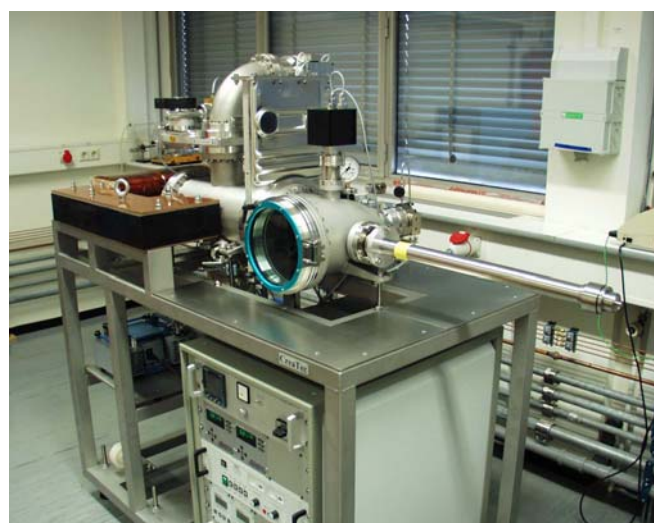
Abb. 3.3: Magnetfeldofen zur Wärmebehandlung der magnetischen Schichten und entsprechendes Schema der Wärmebehandlung im Magnetfeld.
