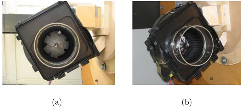
**Abbildung 7.22:** Experimentelle Versuchsanordnung (a) ohne Motorkühlung oMK (b) mit Motorkühlung mMK
