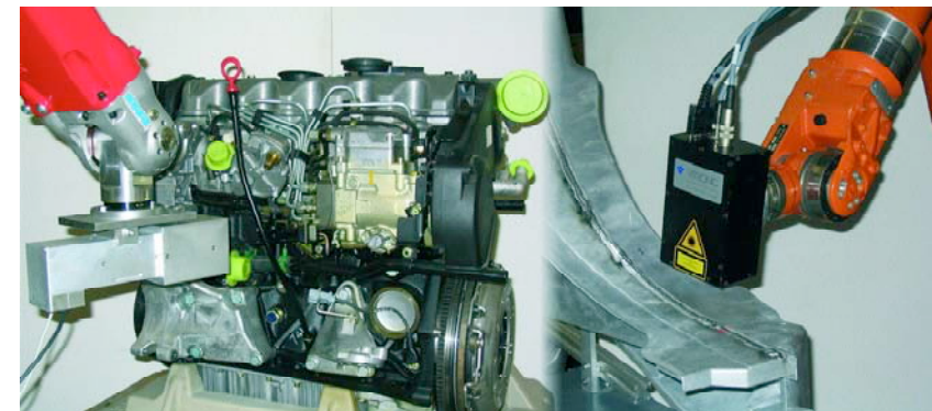
Roboterbasierte Motor- und Schweißnahtinspektion
