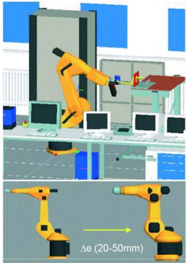
Schnappschuss während einer kollisionsfreien Bahnplanung (oben). Erstellung eines Robotermodells mit einer Ungenauigkeit zwischen 20 und 50mm (unten).
