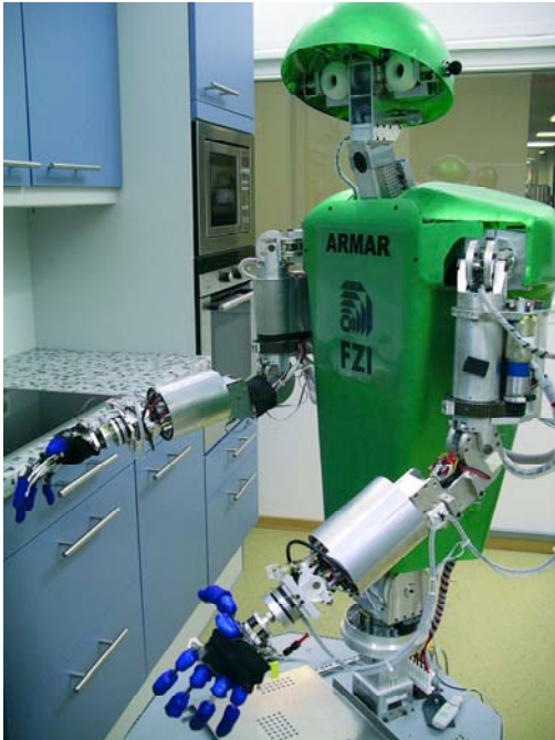
ARMAR verfügt mittlerweile über menschenähnliche Bewegungsabläufe und optimierte Manipulationsfähigkeiten dank seiner an das Steuerungssystem gekoppelten Hände sowie zweier 6D-Kraft-Momenten-Sensoren
