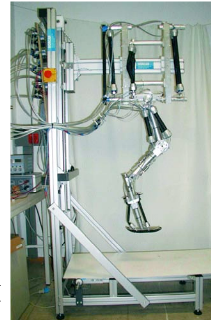
Ein Versuchsbein für den vierbeinigen Roboter PANTER: Neue Antriebskonzepte für biologisch motivierte Roboter sind in der Entwicklung.
