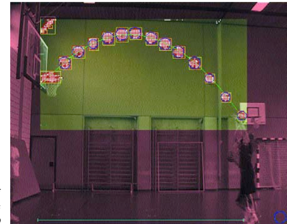
Automatische Ermittlung der Wurfparabel eines Basketballs in 2D
