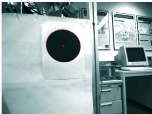
Dabei wird eine Ellipsenanpassung mit einem kleinste-Quadrate-Schätzer auf den Randpunkten der jeweiligen Region berechnet. Das Ergebnis der Ellipsenschätzung (Position und Größe) ist im Bild eingezeichnet.
