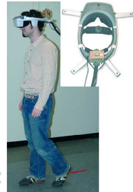
Stereo-Head-Mounted-Display, welches mit Mikrofonen und einem Gyroskopwürfel ausgestattet wurde.
