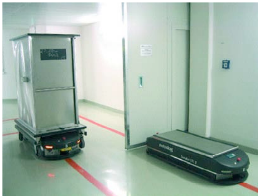
Fahrzeuge der Firma Swisslog Teletlift transportieren Güter in Krankenhäusern. Die Steuerung inklusive einer innovativen freien Navigation wurde am FZI entwickelt.
