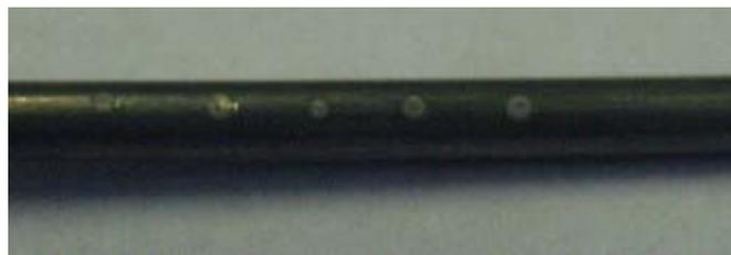
Bild 8-5: Eindrücke in die Oberfläche eines Drahtes mit Crapalverzinkung
