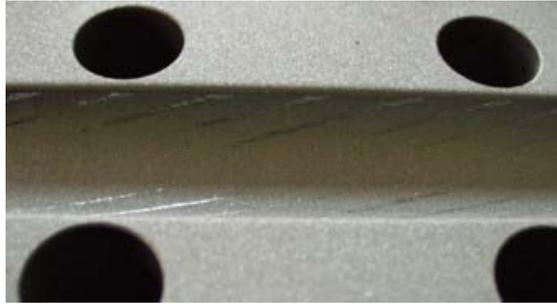
Bild 7-1: Kontaktverhältnisse nach dem Verschiebeversuch an der Seilklemme 20-K1
