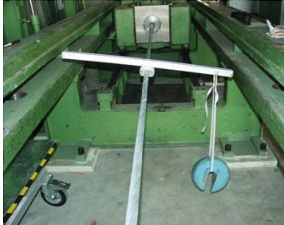
Bild 5-16: Versuchsaufbau der Torsionsversuche
