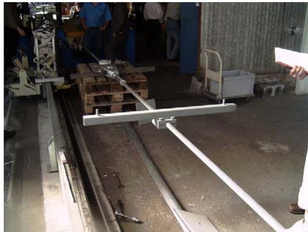
Bild 5-15: Versuchsaufbau Torsionsversuch bei der Fatzer AG, Brugg Seilbautechnik
