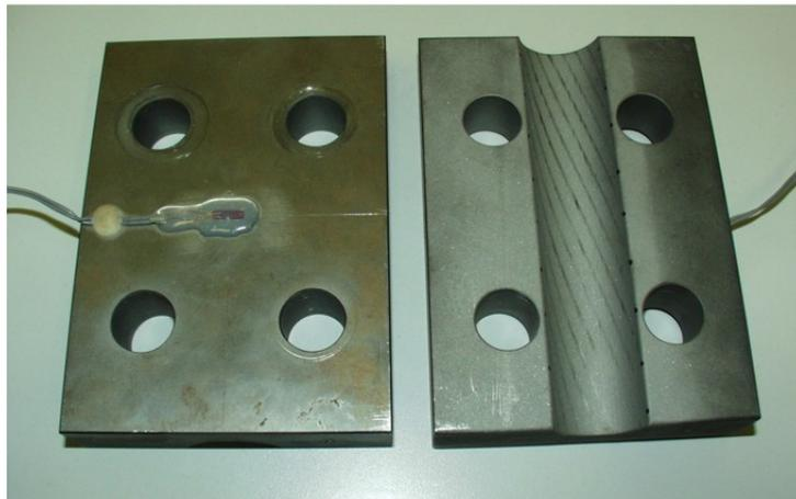
Bild 5-3: Seilklemmenschalen mit Dehnmessstreifen
