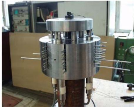
Bild 5-11: Versuchsaufbau mit Drahtberührungspunkten
