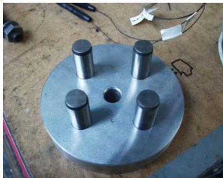
Bild 5-13: Druckplatte im Versuchsaufbau mit Drahtberührungspunkten
