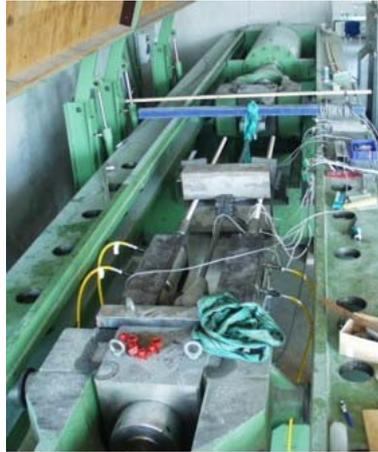
Bild 5-8: Versuchsaufbau der Setzungs- und Verschiebeversuche an den vollverschlossenen Spiralseilen
