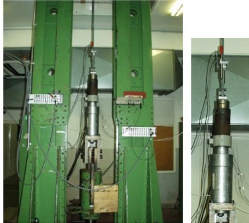
Bild 5-6: Versuchsaufbau und Detail der Verschiebversuche an den offenen Spiralseilen
