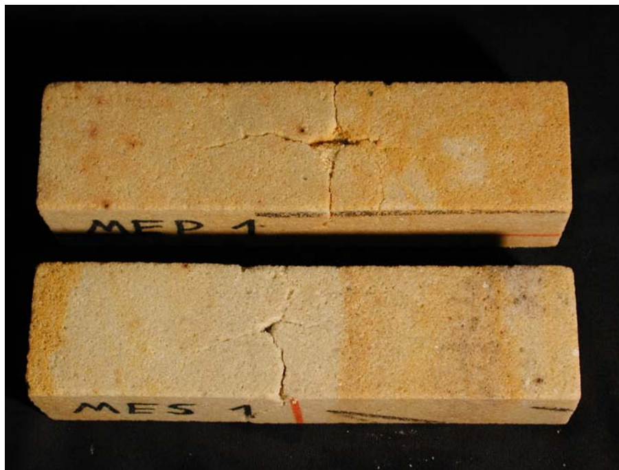
Abbildung 7.8: Sandsteinprismen der Varietät ME nach 82 Beanspruchungszyklen im Frost-Tau-Wechselversuch
