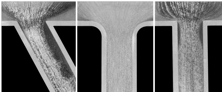
Abb. 2.1: Strömungsvisualisierung durchströmter Bohrungen unterschiedlicher Geometrie (Nakayama, 1988)
