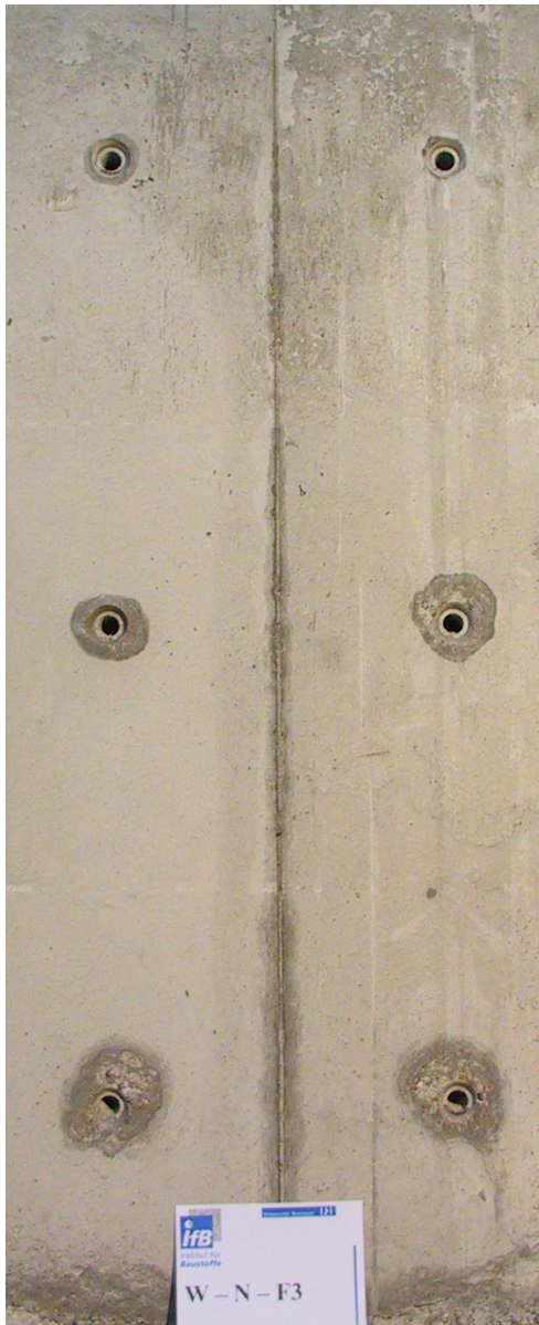
Abb. 7: Sichtbetonproben aus mehlkornarmem Rüttelbeton weicher Konsistenz
