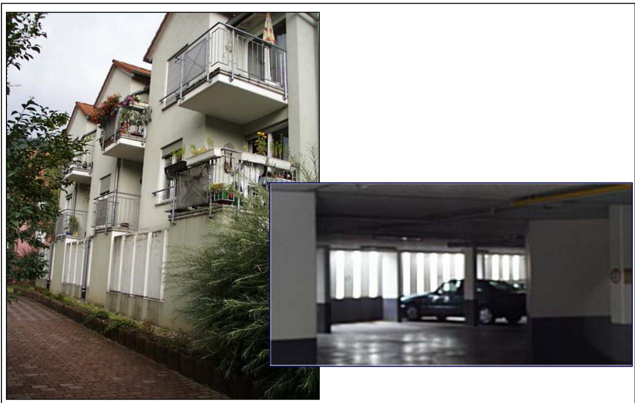
**Abbildung 4-14:** Wohngebäude mit im Hochwasserfall flutbarer Tiefgarage in Neckargemünd
