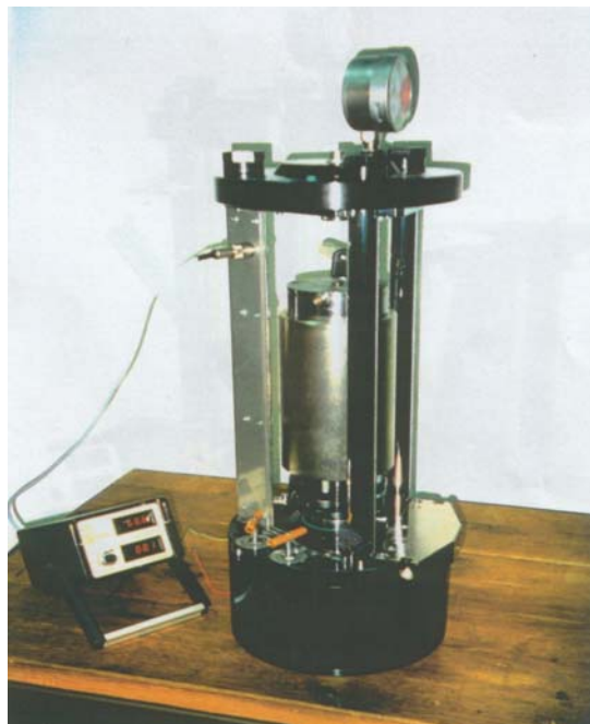
Abbildung 4.2: Hochdruckapparatur U101 (Polish Academy of Sciences).
