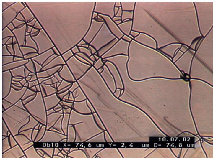
Abb. 3-11 Schäden an der Oberfläche einer COC-Platte, die bereits nach einer kurzzeitigen Einwirkung von Toluoldampf entstanden.
