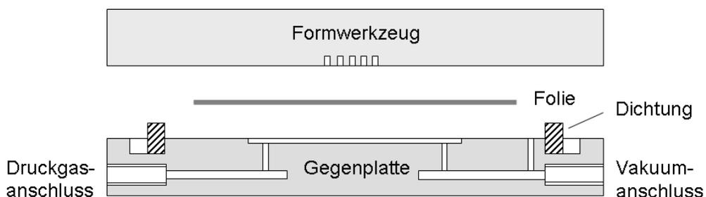
Abb. 3-30 Schematische Darstellung des geöffneten Werkzeugs im Querschnitt. In diesem ersten Schritt wurde das Folienhalbzeug eingelegt.
