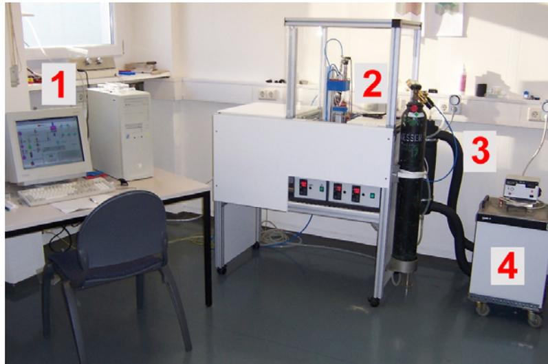
Abb. 3-14 Teilautomatisierte Lösungsmittelschweißanlage für das parallele Verschweißen von 4 Zellkulturträgern: (1) PC für Prozesssteuerung, (2) Rezipient, (3) Kondensationsfalle und (4) Kühlaggregat.
