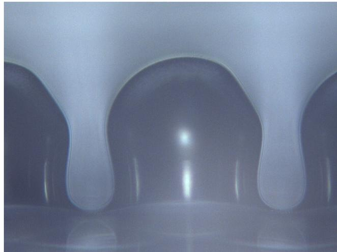
Abb. 3-45 Seitenansicht einer einzelnen Mikrokavität der Druckfolie nach der Trennung der ‚Sandwich‘-Struktur. Aufgrund des leicht an der Kontur zu erkennenden Hinterschnittes der Strukturen kommt es zu einer Deformation beim Trennvorgang.
