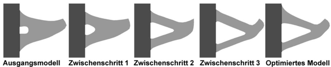
Abbildung 5.30: Entwicklung der Optimierung vom Ausgangsmodell über drei Zwischenschritte zum optimierten Modell
