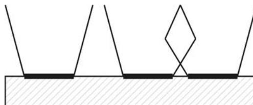
Abbildung 2.6: Adsorption von Polymeren am Substrat nach [16]
