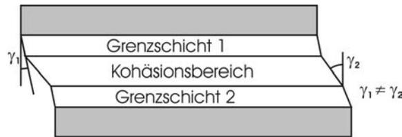
Abbildung 2.7: Verschiebung in einer Klebeschicht unter Schubbelastung
