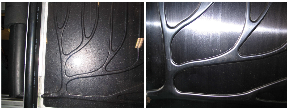
Abbildung 7.16: Beschichtete FracTherm -Absorber; links: Solarlack, rechts: selektive Beschichtung
