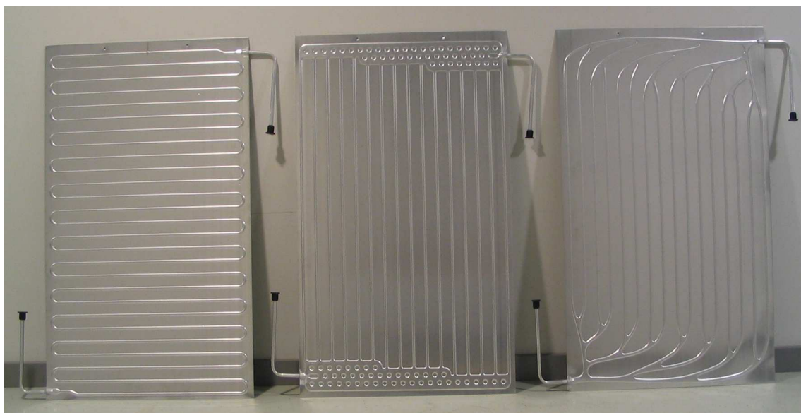
Abbildung 7.14: Rollbond-Testabsorber (jeweils 590 mm x 1000 mm; noch unbeschichtet)
