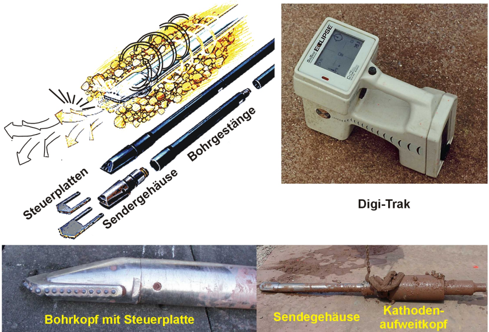
Abb. 5-20: Steuerbarer Bohrkopf mit Sender (links) und Ortungsgerät Digi-Trak (rechts oben) zur Herstellung der Pilotbohrung und Aufweitbohrkopf (rechts unten) zur Erstellung der Sachlochbohrung.
