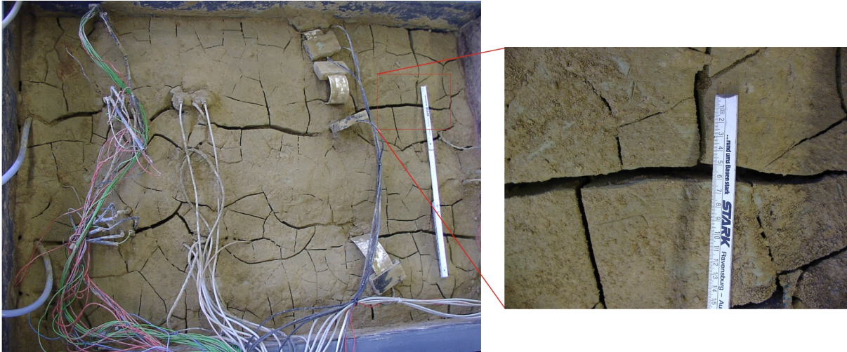
Abb. 6-47: Elektroosmotisch bedingte Schrumpfungsrisse im Technikumsversuch 1.
