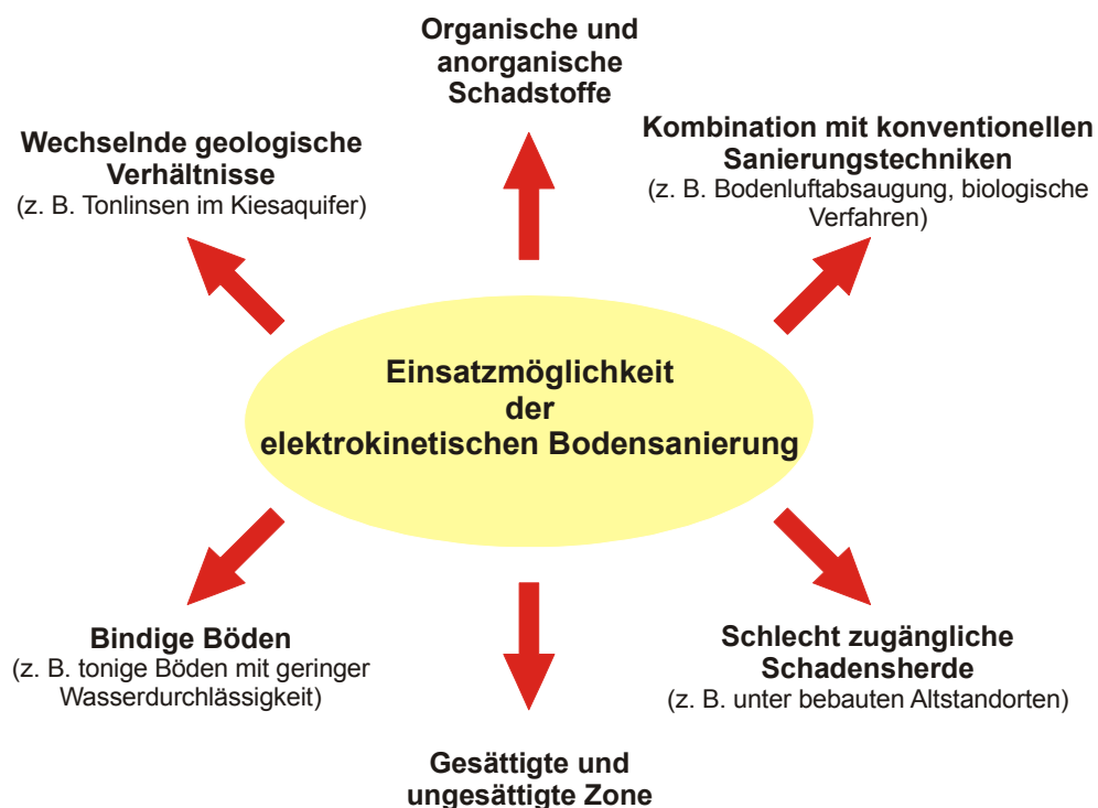
Abb. 1-1: Anwendungsbereiche der elektrokinetischen Bodensanierung (nach ZORN 2005).
