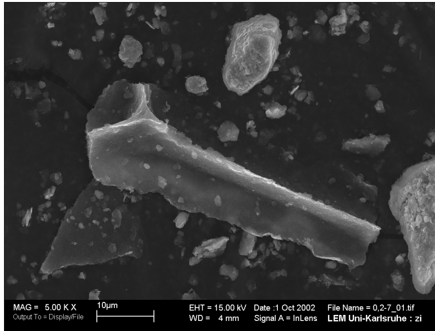
Abb. 6-39: Randlich zerlapptes blättchenförmiges Mineral in der Fraktion <0,2 \mu\text{m} mit einer sich verzweigenden stäbchenförmigen Verdickung, die sich mitten durch das Blättchen zieht)
