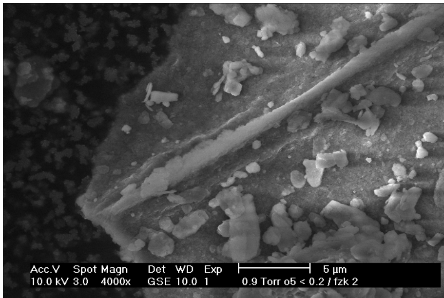
Abb. 6-49: Tonmineralaggregat mit aufgebogenem "Röllchen" in der Mitte; Fraktion <0,2 µm
