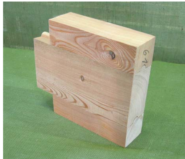
Bild 4-26 Prüfkörper zur Ermittlung der Haftungs- und Reibungskoeffizienten mit (a) gehobelten Oberflächen und (b) Nut- und Federverbindung (Holzart: Lärche)
