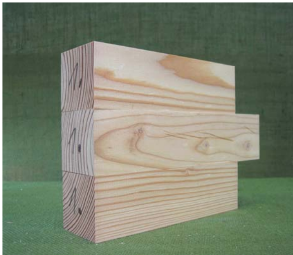
Bild 4-26 Prüfkörper zur Ermittlung der Haftungs- und Reibungskoeffizienten mit (a) gehobelten Oberflächen und (b) Nut- und Federverbindung (Holzart: Lärche)
