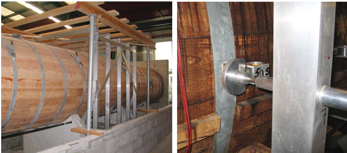
Bild 7-11 Versuchsstand: Messrahmen und Wegaufnehmer zur Bestimmung von Verformungen in Längsrichtung und Querschnittsverformungen
