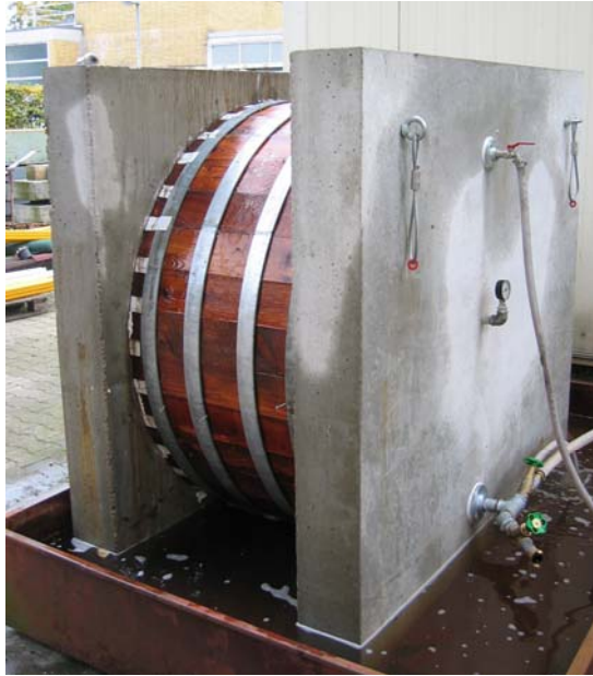
Bild 11-2 Versuch: optimierter Anschluss Holz - Beton
