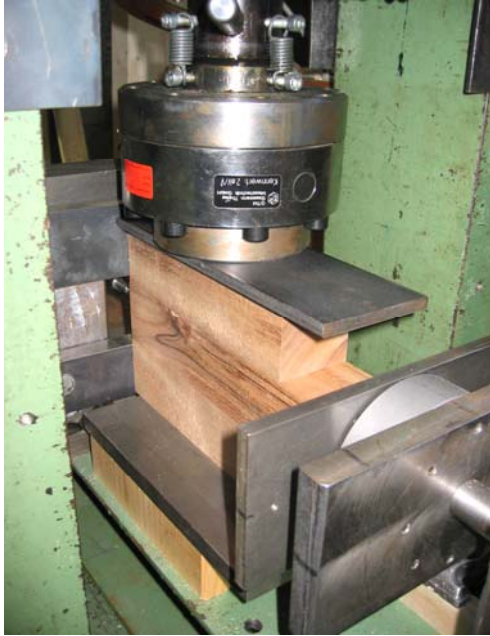
Bild 4-25 Versuchsaufbau zur Ermittlung der Haftungs- und Reibungskoeffizienten
