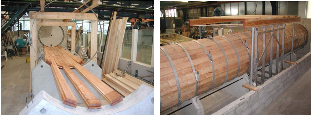
Bild 7-5 Versuchsstand zur Untersuchung des Biegetragverhaltens von Druckrohr- leitungen aus Holz
