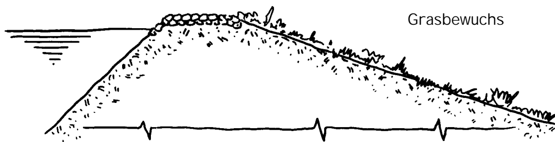
Abb. 3.1 Mit Grasbewuchs „gesicherte“ Dammoberfläche (Quelle: BOSSHARD 1991)
