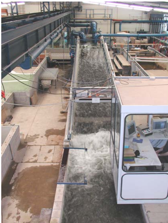
Ansicht von unterstrom: q = 200 \text{ l/(sm)}
