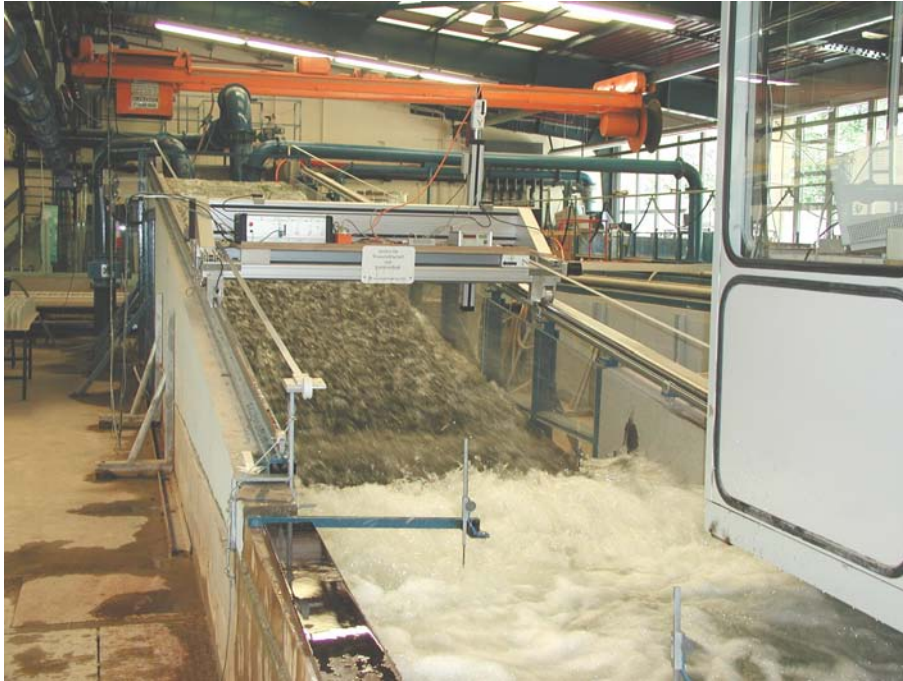
Abb. 5.21 Ansicht des Halbdamm-Modells von unterstrom bei q = 300 \text{ l/(sm)} (Foto: Queißer 2001)
