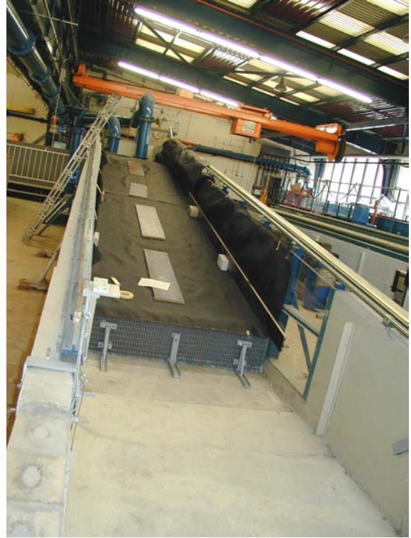
Aufbringen des Filters aus Geogewebe
