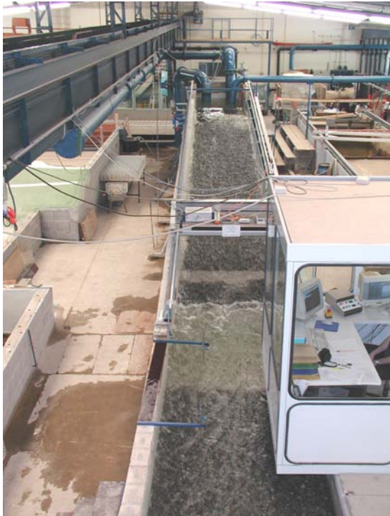
Ansicht von unterstrom: q = 50 \text{ l/(sm)}
