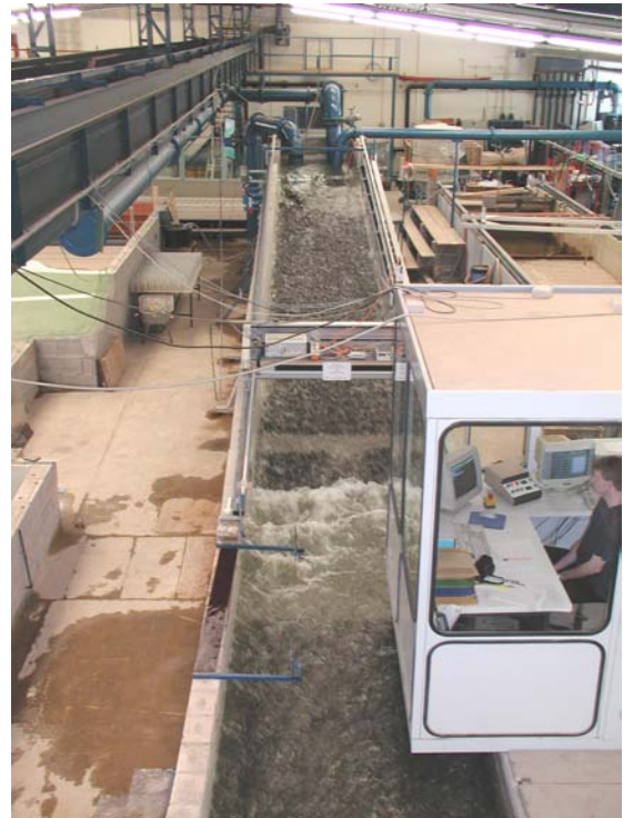
Ansicht von unterstrom: q = 100 \text{ l/(sm)}
