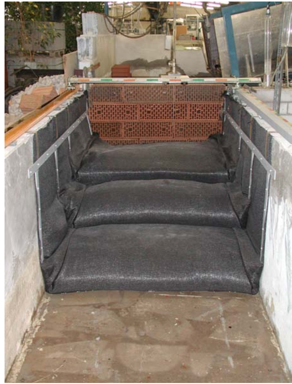
Endzustand nach Überströmung mit q_{\text{Modell}} = 180 \text{ l/(sm)} bzw. q_{\text{Natur}} = 710 \text{ l/(sm)}
