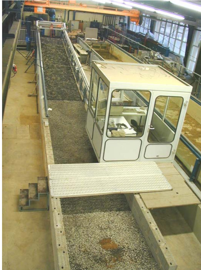
Abb. 5.14 Gesamtansicht des Halbdamm-Modells mit Messcontainer (Foto: Queißer)
