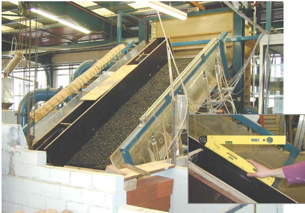
Abb. 5.11 Bestimmung des Reibungswinkels im trockenen Zustand zu 31,3^\circ (Fotos: IBF)
