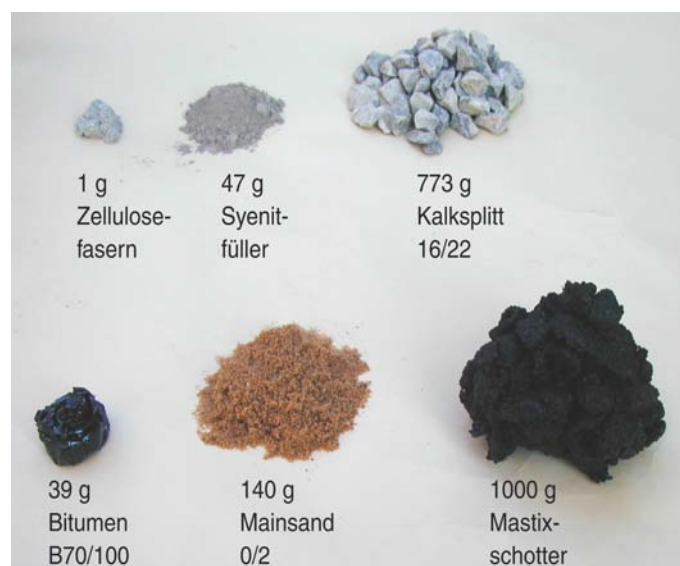
Abb. 5.23 Bestandteile des Mastix-Schotters (Quelle: BIEBERSTEIN ET AL. 2004a)
