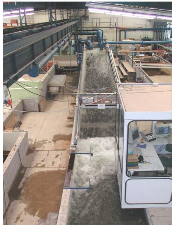
Ansicht von unterstrom: q = 300 \text{ l/(sm)}
