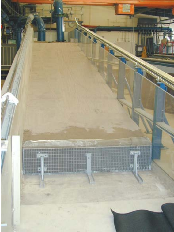
Dammkörper ohne Böschungssicherung
