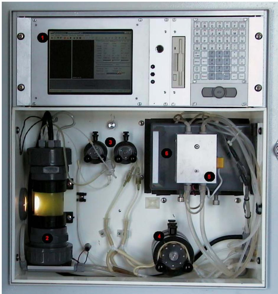
**Abb. 8:** Frontansicht des bbe-Daphnientoximeter. 1= LCD- Farbdisplay, 2 = Algenfermenter, 3 = Dosierpumpen für Futteralgen und Algennährlösung, 4 = Probenwasserpumpe, 5 = Peltierelemente, 6 = Gehäuse der Messkammern
