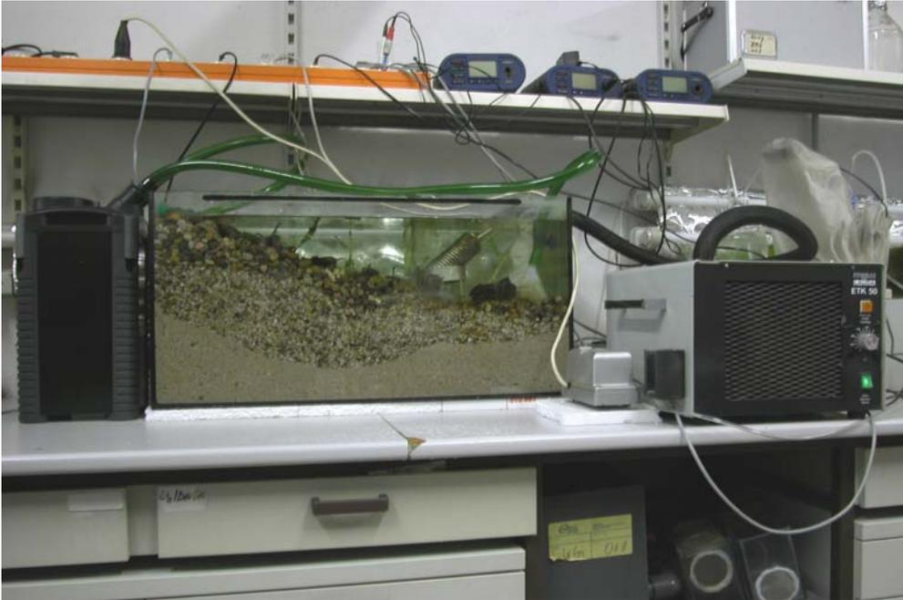
**Abb. 6:** Halterung von *G. roeseli*. Zu sehen ist das mit Kies unterschiedlicher Korngroen befüllte 150 Liter Aquarium, der Eheim-Auenfilter (links) und das Kuhlgerat (rechts).
