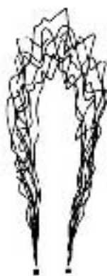
Abbildung 2.3: Übereinandergelagerte Momentaufnahmen einer Reaktionszone [6] für Re > Re_{kr}
