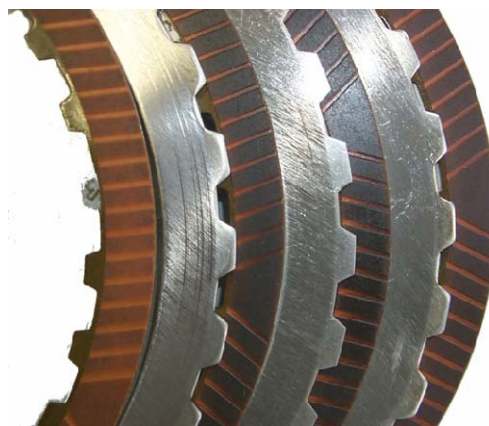
Bild 31: unterhalb der Leistungsgrenze beanspruchtes Lamellenpaket im Versuch V3
