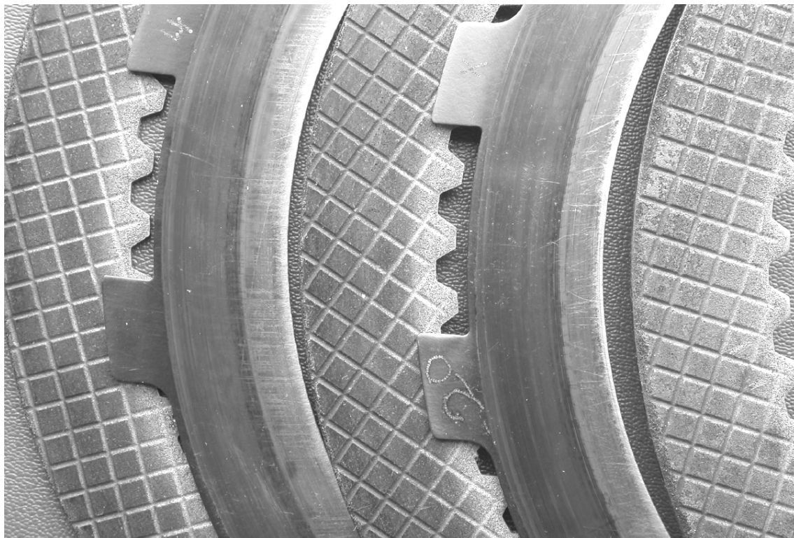
Bild 121: Sinter- und Stahllamellen im gelaufenen Zustand
