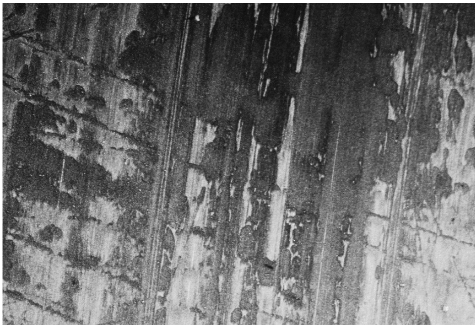
Bild 112: Typisch Verschleißerscheinung bei Sinterübertragung „Leopardenfell“
