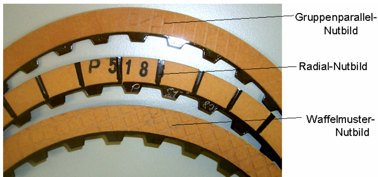
Bild 4: eingesetzte Innenlamellen der Lamellenbaugröße I mit dem Nutbild Radial(R), Kamm/Gruppenparallel(K/GP) und Waffelmuster (WM)
