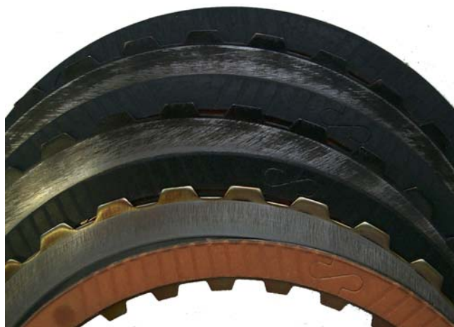
Bild 28: Durchgebrannten Lamellen nach thermischer Überlastung „Oberhalb der Leistungsgrenze“
