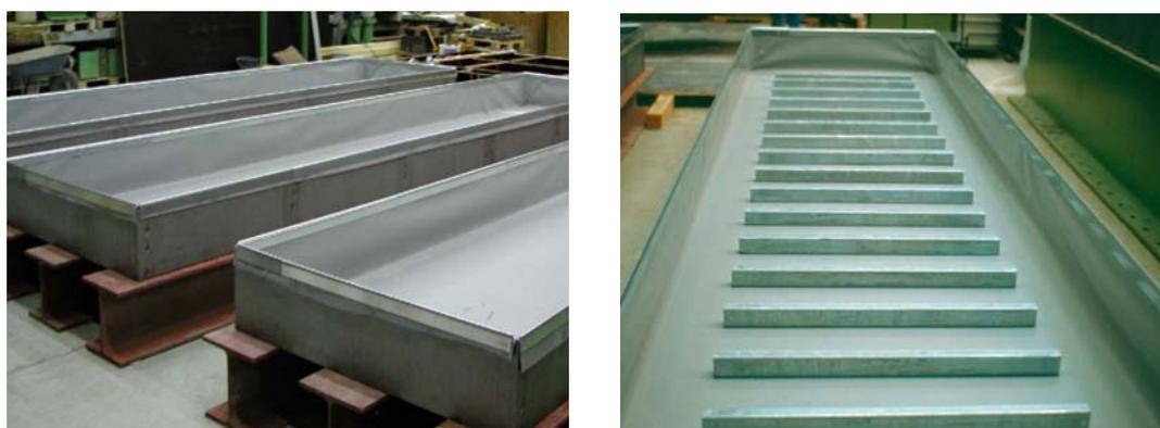
Abb. 3.1: Ausgekleidete Blechwannen auf Stahlträgern (links) und in die Wannen eingebaute Rohr Stahlprofilen zur Lagerung der großen Betonplatten (rechts)
