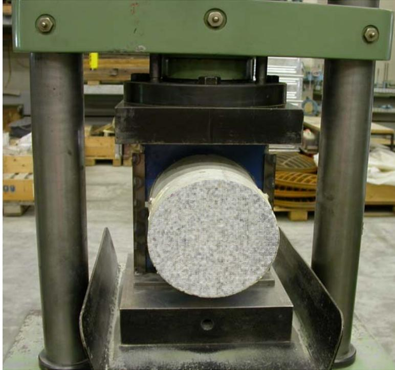
Abb. A 3.16: Abspalten von Betonscheiben aus Zylinderproben, die neben den großen Platten lagerten, zur gravimetrischen Bestimmung des Feuchtegehalts über die Querschnittshöhe
