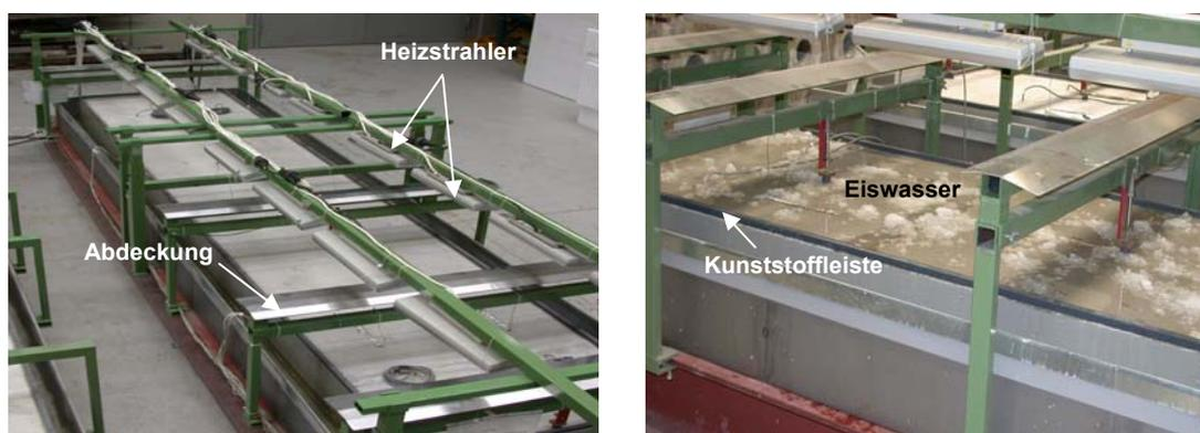
Abb. 3.18: Anordnung der Heizstrahler und Abdeckung der Wegaufnehmer während der Durchführung der thermischen Beanspruchung der großen Betonplatten (links) und Abkühlung der Platten mittels Eiswasser (rechts)
