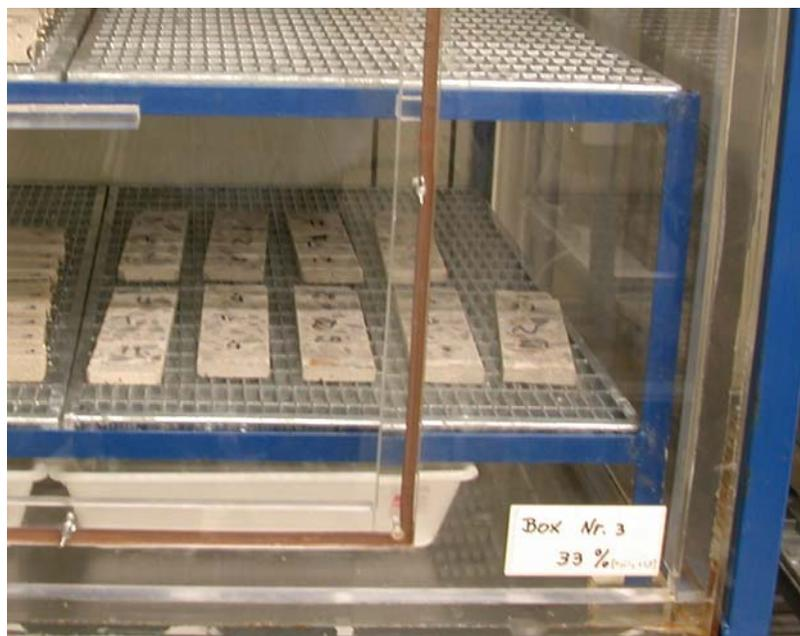
Abb. A 3.17: Lagerung von Betonproben ( $200 \times 50 \times 10 \text{ mm}^3$ ) in Klimaboxen zur Bestimmung der Sorptionsisothermen
