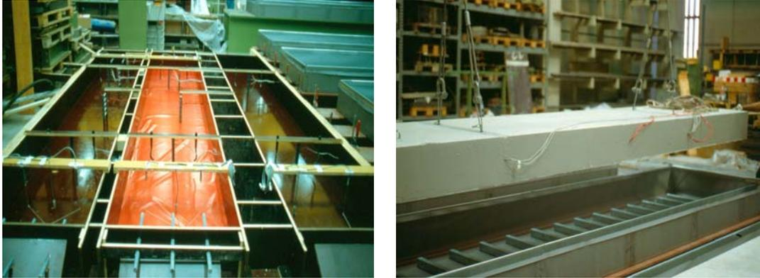
Abb. 3.6: Schalungselemente für die großen Betonplatten versehen mit eingebauten Messeinrichtungen, Transportankern und einer Versiegelung an der Unterseite der Platte 1 (links) sowie Transport und Einsetzen der großen Betonplatten in die wasserdichten Blechwannen (rechts)
