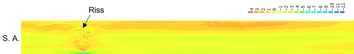
Abb. 4.17: Spannungsverteilung (N/mm<sup>2</sup>) in Platte 4 (Verformungsbehinderung an den Enden) nach 360 Tagen
