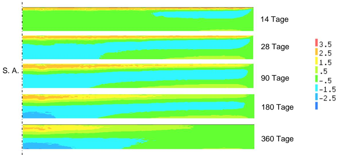
Abb. A 4.1: Spannungen in der Hälfte der Platte 1 (Austrocknung oben) zu verschiedenen Zeitpunkten nach einer Nachbehandlungsdauer von einer Woche
