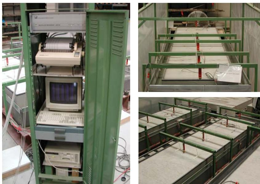
Abb. 3.7: Durchführung der Versuche an großen Betonplatten. Links: Messanlage; rechts oben: Platte 3 (Windsimulation mit Hilfe eines Ventilators); rechts unten: Platten 1 und 2
