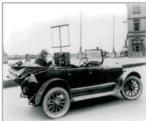
(a) Kfz-Kommunikationslösung aus dem Jahre 1924. Copyright: Lucent Technologies [79]
