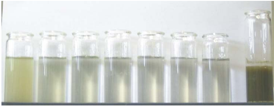
Abbildung 6.37 Filtrat von Magnetit-Akaganéit-Aggregaten von 7 Zyklen und Konzentrat (rechts); in Reihenfolge von links nach rechts: 1. Zyklus bis 7. Zyklus
