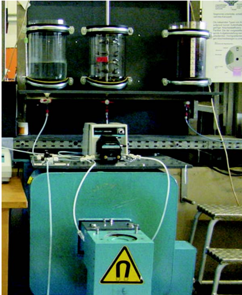
Abbildung 6.34 HGMS-Anlage mit Reinigungsbehälter, Vorlagebehälter, Zuläufen, Pumpe, Filterkassette und Permanentmagnet
