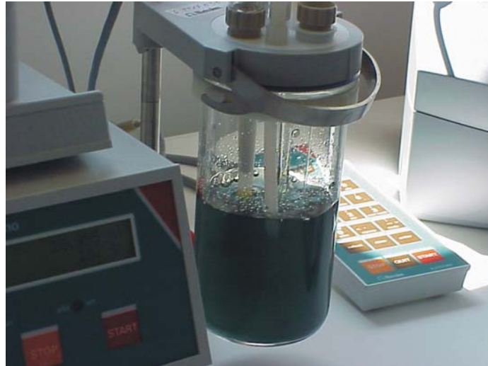
Abbildung 3.3 Reaktionsgefäß zur Herstellung von magnetischen Partikeln und Aggregaten (mit einer Suspension von Grünem Rost)
