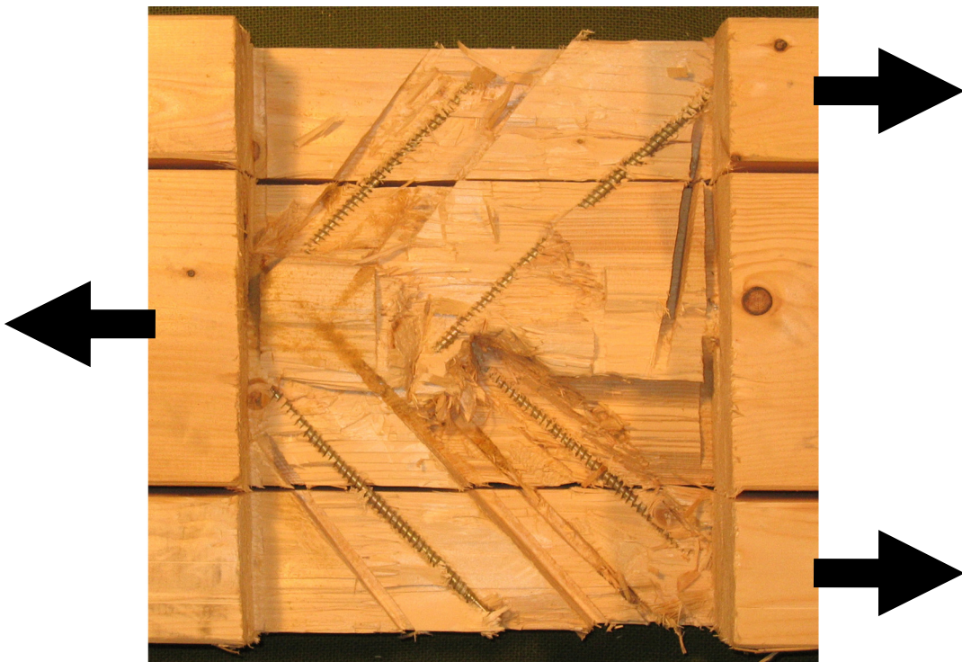
Bild 4-4 Geöffneter Versuchskörper mit geneigt angeordneten Schrauben
