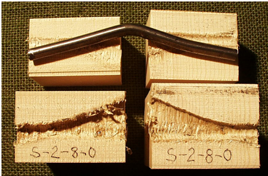
Bild 5-24 Schnitt durch einen unverstärkten Versuchskörper der Reihe S-2-8-0
