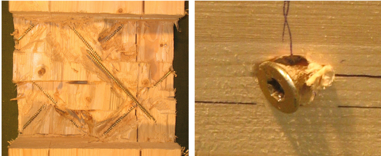
Bild 4-5 Links: Versuchskörper mit gekreuzt angeordneten Schrauben Rechts: Herausdrücken einer auf Druck beanspruchten Schraube aus dem Seitenholz
