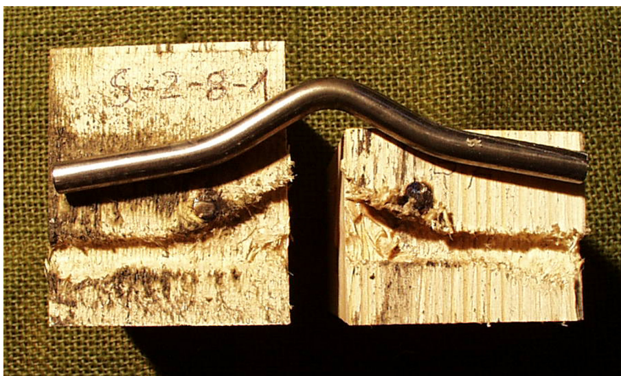
Bild 5-25 Schnitt durch einen verstärkten Versuchskörper der Reihe S-2-8-1
