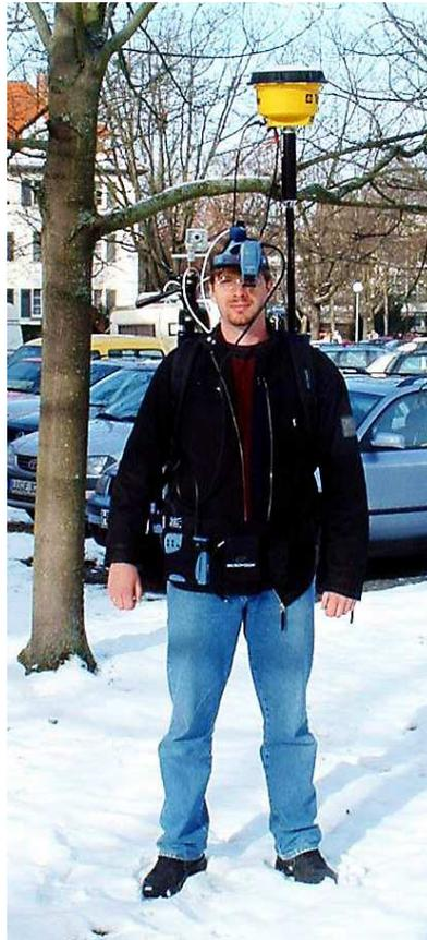
Abbildung 4.2: Systemaufbau bei Anzeige mithilfe einer halbdurchlässigen Brille
