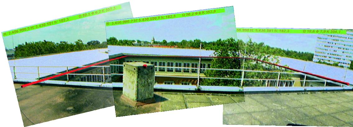
Abbildung 3: A l'aide du seul système RTK, la gouttière dessinée en rouge ne pourrait pas être mesurée.
