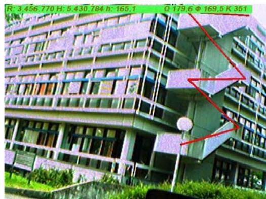
Abbildung 7: Esquisse tridimensionnelle faite à l'aide du système conformément au croquis manuel dans l'illustration 6.
