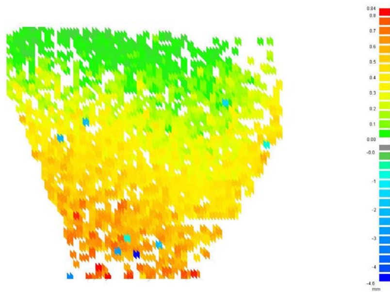
Abb. 6.9. Tiefenbildaufnahme im Winkel 30^\circ zwischen Diagonale und xy-Ebene (Regressionsebene)
