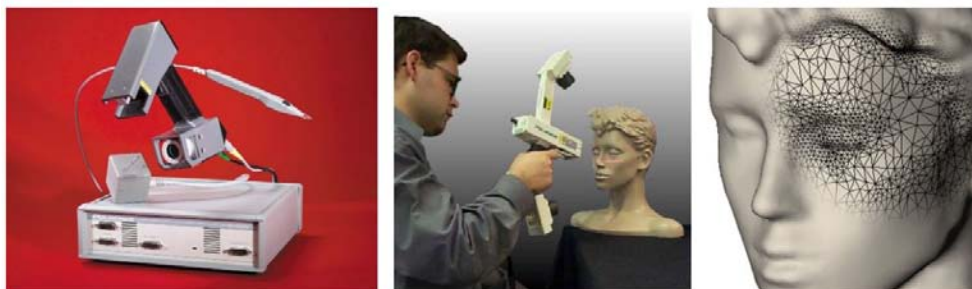
Abb. 2.23. System FastSCAN Cobra der Fa. Polhemus Inc. [Polhemus 04]
