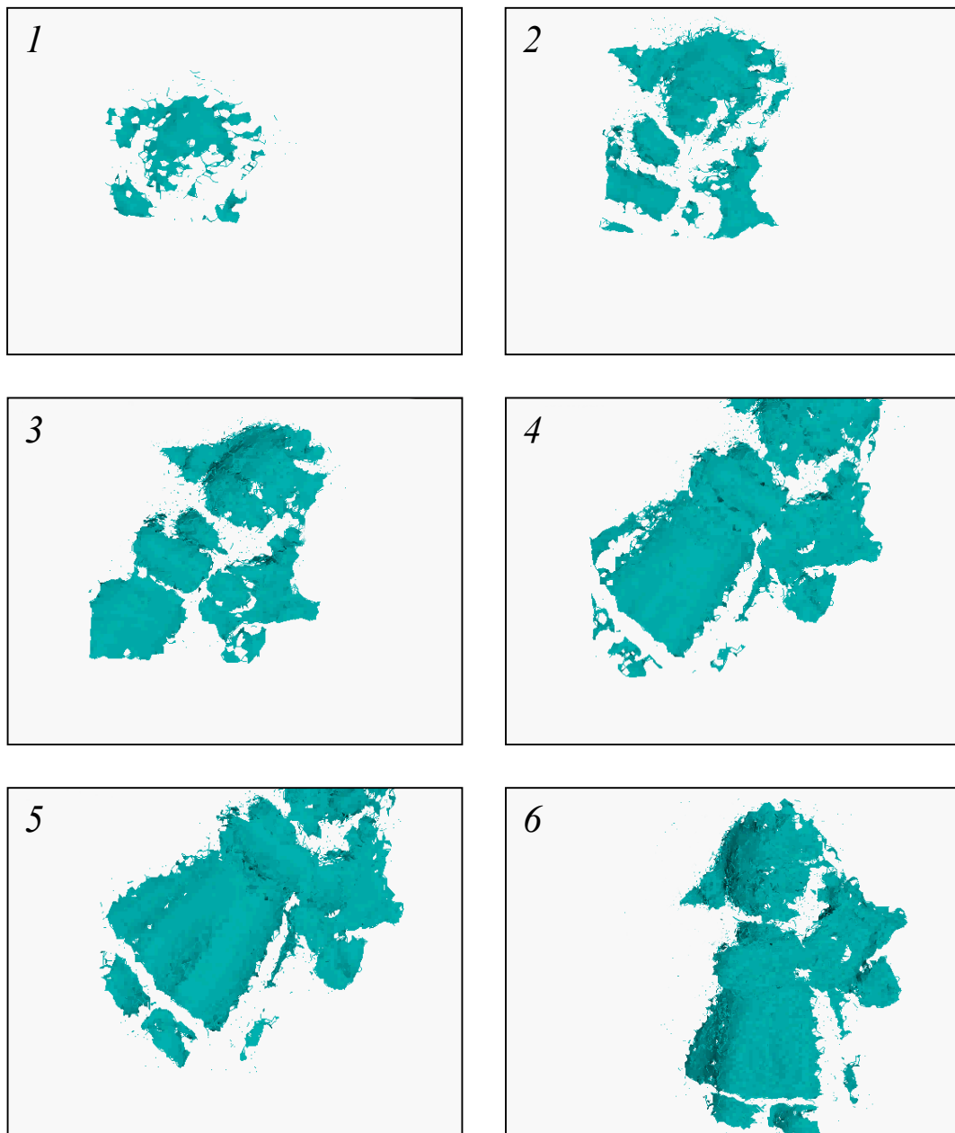
Abb. 6.19. Fortlaufender 3D-Scan der kleinen Engelsfigur aus Abb. 6.18 (links oben) – manuelle, translatorische Bewegung des Objektes
