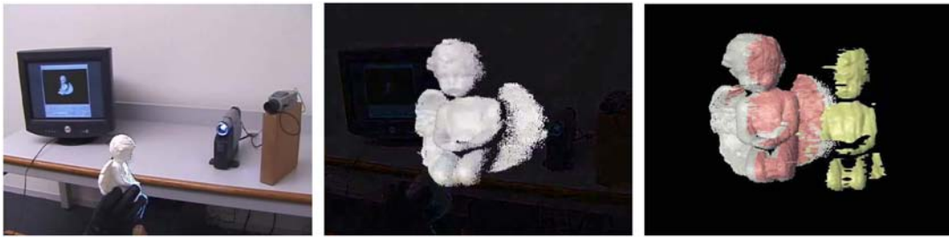
Abb. 2.28. Laboraufbau von Rusinkiewicz (Projektor und Digitalkamera), halbferdiges 3D-Modell einer Engelsfigur und manuelle Rückführung durch den Anwender nach Versagen der Registrierung [Rusinkiewicz 01a]
