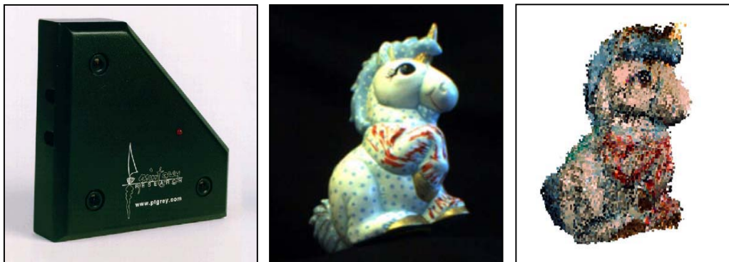
Abb. 2.32. Verwendetes trinokulares Kamerasystem, Beispielobjekt (Einhornfigur) und resultierendes 3D-Modell [Liu 03ab]
