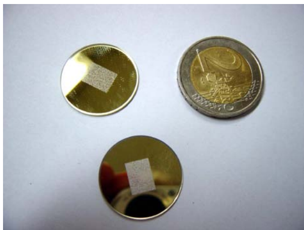
Abb. 5.7. Gobos mit Gold-auf-Glasbeschichtung
