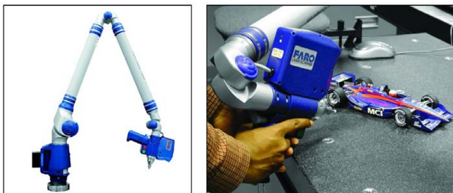
Abb. 2.19. 3D-Scanverfahren basierend auf mechanischem Tracking [Faro 04]
