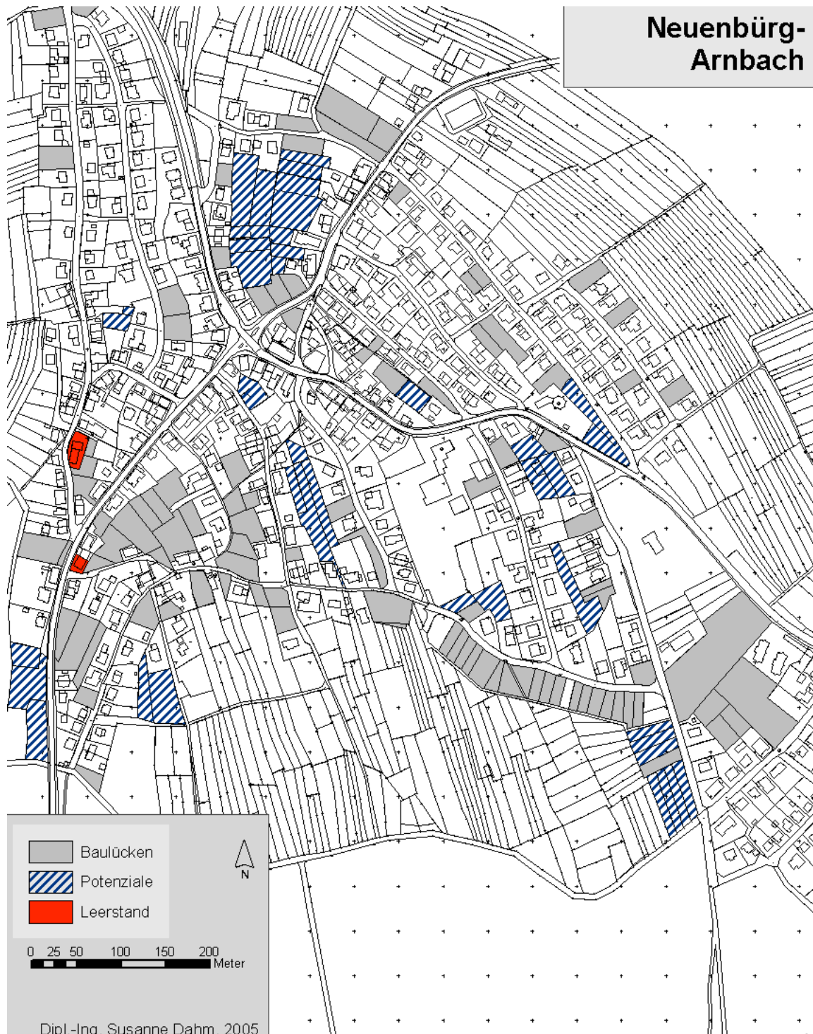
Abb. 83: Baulücken, Potenziale, und Leerstand in Neuenbürg-Arnach; Daten: Stadt Neuenbürg, eigene Erhebung
