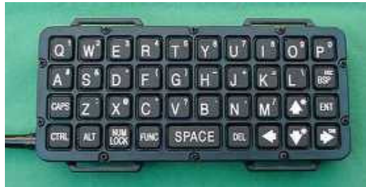
Abbildung 5.8: Unterarmtastatur nach [L3 SYSTEMS 2005]
