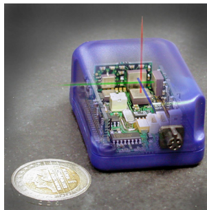
Abbildung 4.4: Xsens IMU (Quelle: [Xsens 2005])
